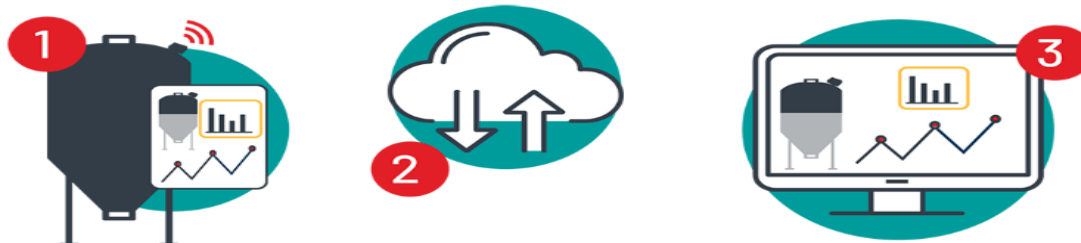
3. ábra: A SiloSpi adatgyűjtésének lépései; siló, a sigfox felhőbe, a web / alkalmazásba
