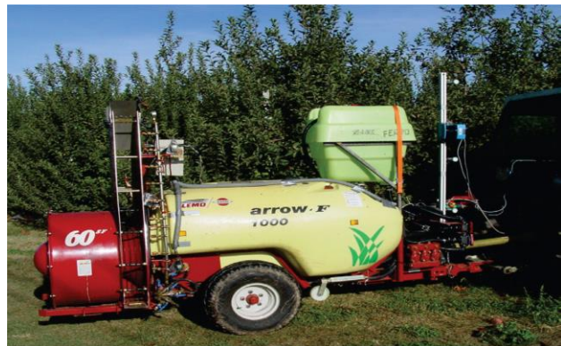
Sensori a ultrasuoni e LIDAR equipaggiati con irroratori ad assistenza pneumatica. Fonte: Petrovic
