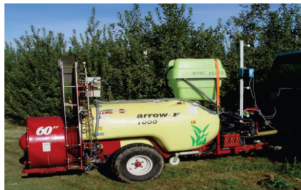
Ultrasonic és LIDAR érzékelőkkel felszerelt levegő rásegítős permetező Forrás:: Petrovic et al
