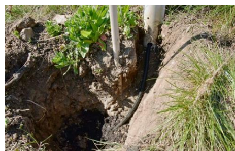
Installazione dei sensori nel terreno per la rilevazione di sostanze nutritive.
