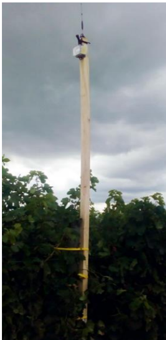
Unità di controllo dei sensori impiantati nel terreno
