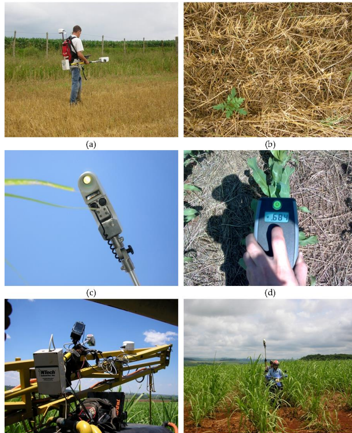
Il sensore GreenSeeker per la raccolta dei valori NDVI nel manto erboso (a) e (b); dettaglio del dispositivo GreenSeeker Hand Held (c) e del Pocket Sensor (d); e sensore GreenSeeker montato su un irroratore (e) e su un ciclomotore (f) per raccogliere i valori NDVI nella canna da zucchero.
