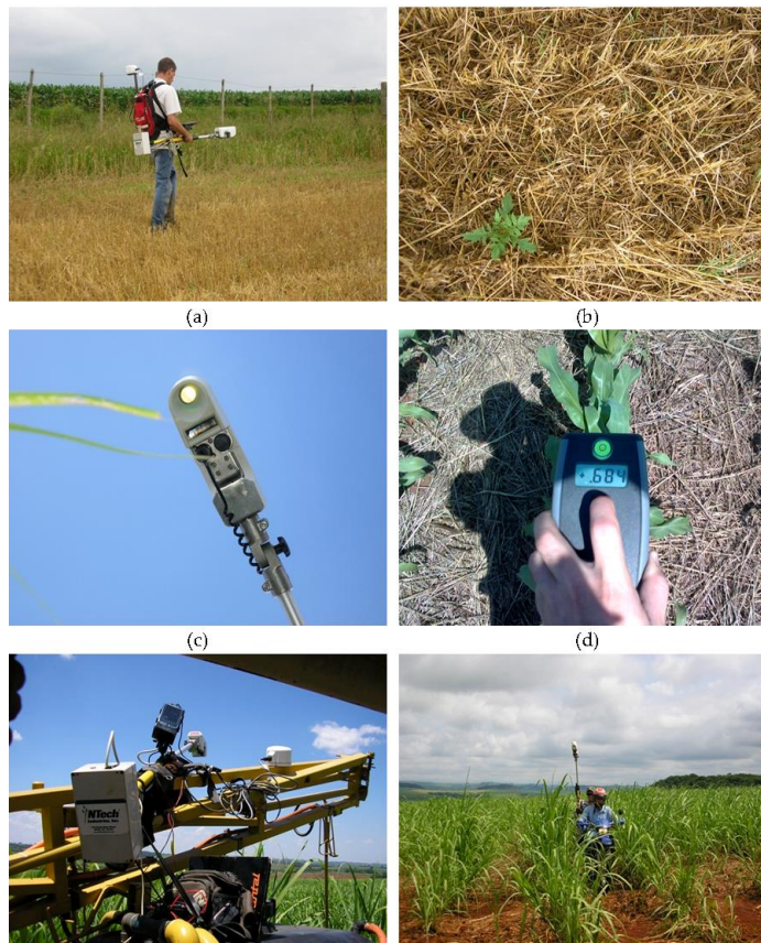
GreenSeeker érzékelő, amely az a) és b) gyomnövény NDVI-értékeit gyűjti; részletes képek a GreenSeeker Hand Held (c) és Pocket Sensor (d) fájlokból; és a GreenSeeker egy permetezőgépre (e) és egy motorkerékpárra (f) szerelve, amely cukornádban gyűjti az NDVI értéket. Forrás: https://www.intechopen.com/chapters/46140 .
