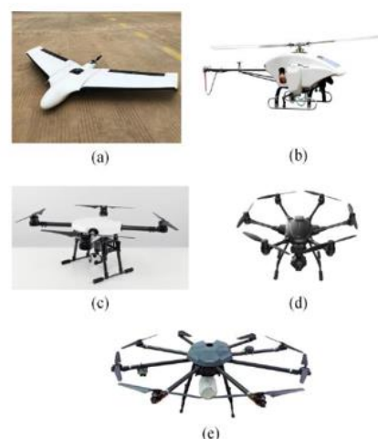
a) merev szárnyak, b) egymotoros, c) quadcopter, d) hexacopter, e) octocopter (Forrás 3)
